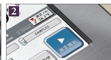
2 スタート 蓋を開けて、測定開始を押します。
