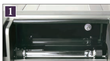
1 サンプルセット 観測管にサンプルを入れ、セットします。
