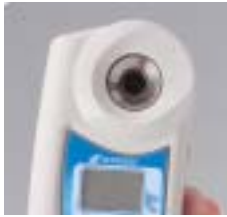
Vérification du prisme.
